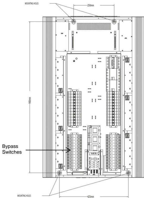
**2-12: Bohrungen (engl.: Mounting Holes) für Wandmontage (Bypass)**
