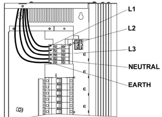
2-5: Einspeisung bei der 6- und 12-Kanalversion (ohne RCD)
